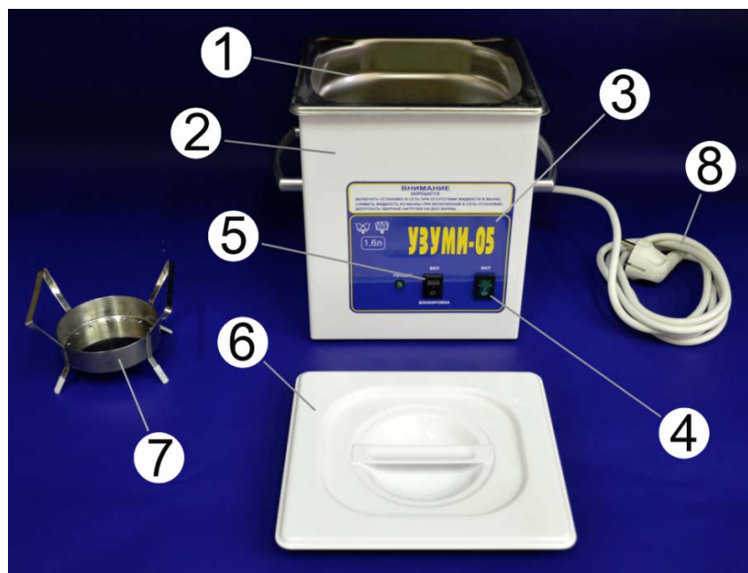
Рис. 1. Общий вид установки "УЗУМИ-05". 1 - ультразвуковая ванна; 2 - корпус установки; 3 - лицевая панель; 4 - сетевой переключатель; 5 - переключатель блокировки включения ультразвука; 6 - крышка ванны; 7 - поддон-кассета; 8 - сетевой кабель.
