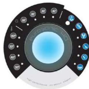
Голубой мигающий свет Нагревающий элемент в работе.
